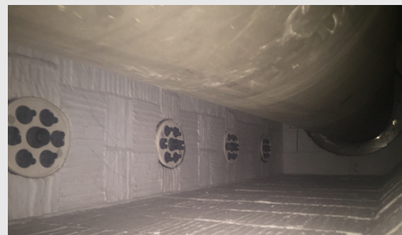
新工业炉内部：再生式无焰氧化燃烧器
