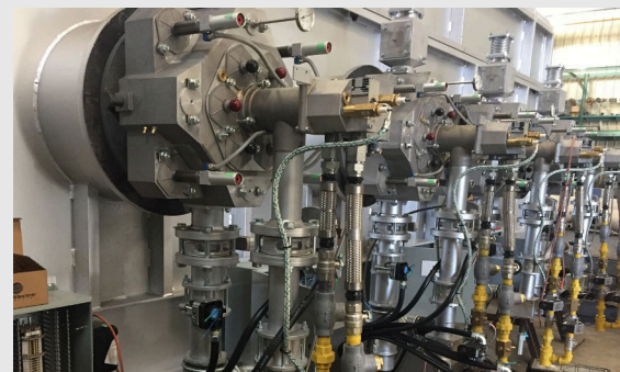
新的工业炉使用了蓄热燃烧器和安全PLC控制
